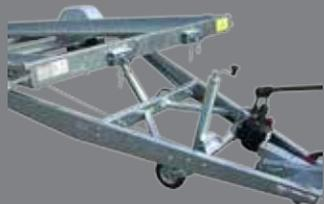
Kit hydraulique de basculement
