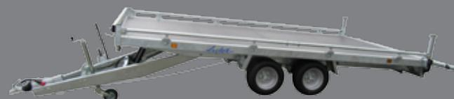
Main courante latérale kit hydraulique de basculement + hayon
